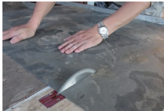
使用圓鋸切割機台裁切即可輕鬆裁切成所需規格，亦可使用剪刀切割。以裁切精準、平直為考量，選擇適合的裁切工具。
