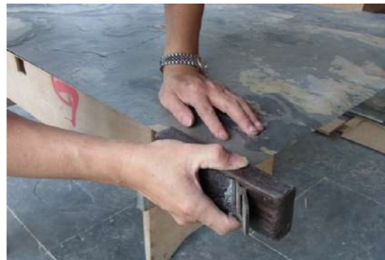
使用刨刀將切口修齊平整，如切口有裂痕不平的部分可用磨砂紙輕輕擦拭去除。
